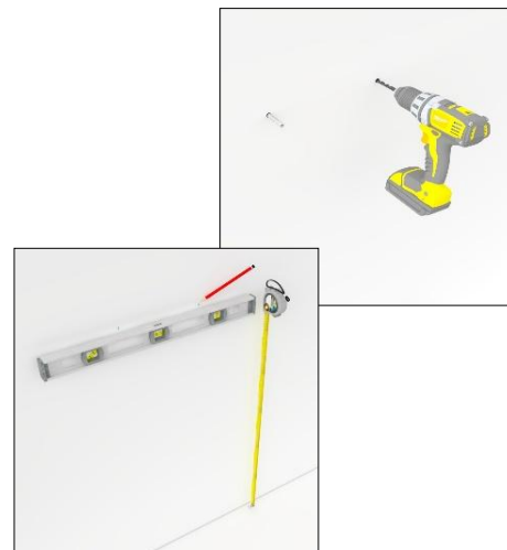
3. Aftekenen en boren van gaten in wand
