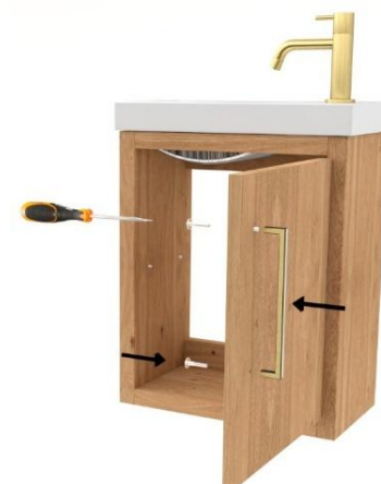
6. Greep aftekenen, boren en monteren (niet van toepassing bij Push to open front)
