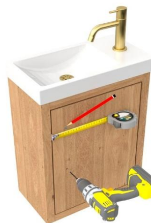
6. Greep aftekenen, boren en monteren (niet van toepassing bij Push to open front)
